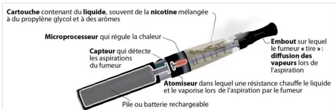
Figure 1 : Composition d'une cigarette électronique
