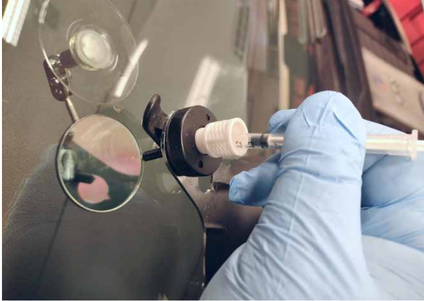
▲ La résine de réparation est appliquée par le biais du piston
