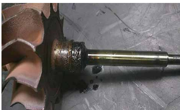
Photo 4 - L'arbre de la turbine est visiblement décoloré, bleui
