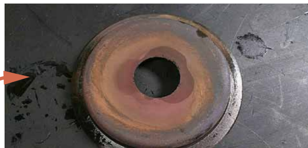
Photo 5 - La cloche thermique est rouge
