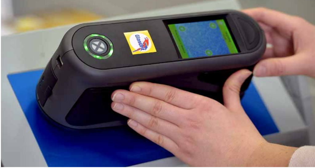
Un spectromètre peut permettre à un atelier de carrosserie de travailler plus rapidement et avec plus de précision (Photo: BASF)
