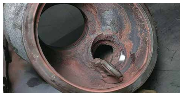
Photo 6 - Tout indique une surchauffe, il suffit de regarder comment le carter de turbine est déformé
