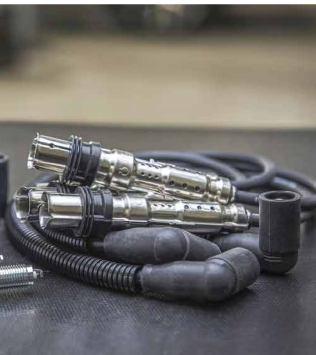
Le faisceau entre les bougies et les bobines d'allumage joue un rôle important dans le système d'allumage d'un moteur à combustion
