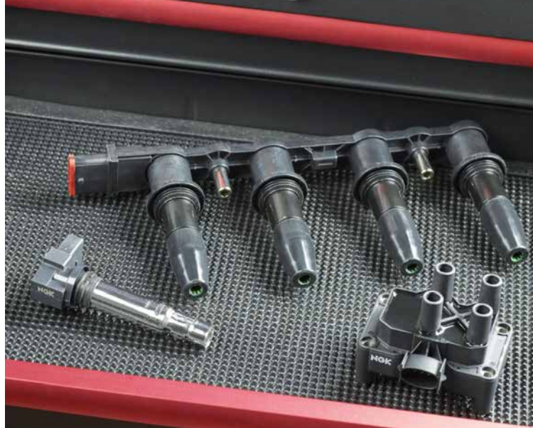
Toutes sortes d'évolutions ont contribué au développement de différents types de bobines d'allumage au fil des ans
