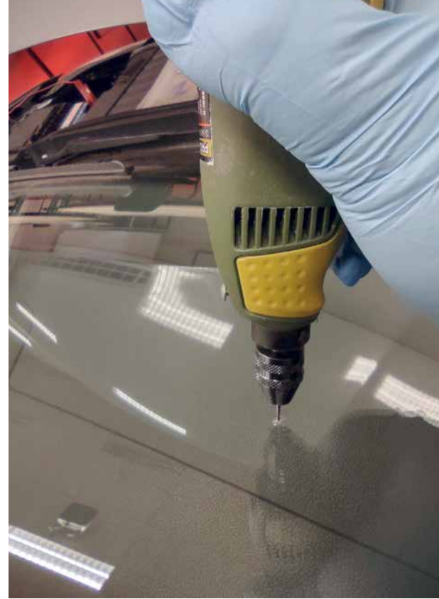
► Un petit trou est percé à l'aide d'une mèche spéciale afin d'accéder à la fissure en profondeur
