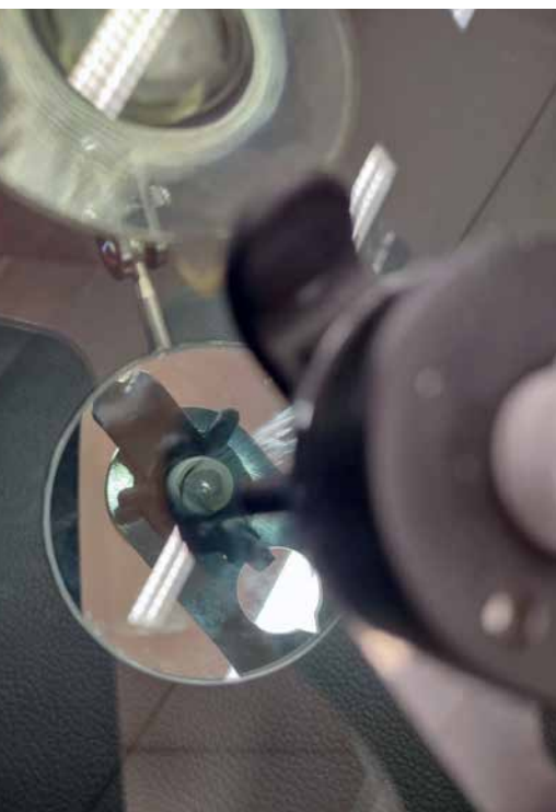
En utilisant un miroir à l'intérieur du pare-brise, nous essayons d'être aussi précis que possible. Un outil utile pour une réparation réussie
