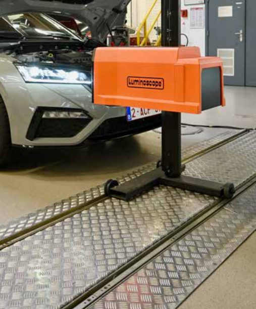
Le dispositif de contrôle des feux se déplace sur deux rails assemblés
