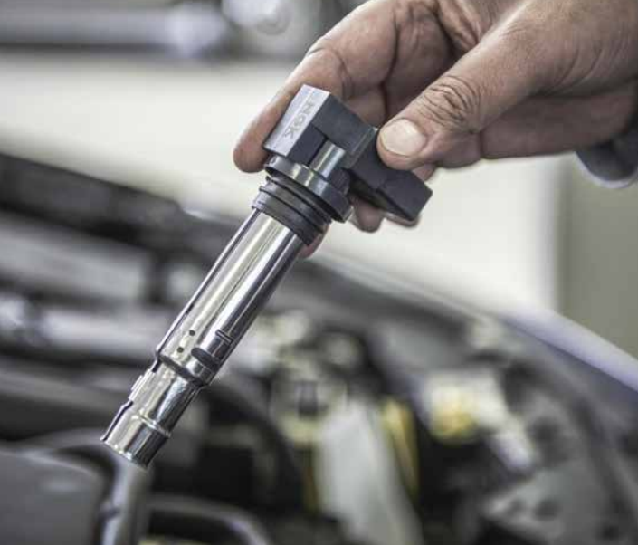
Een penbobine is rechtstreeks aangesloten op de bougie
