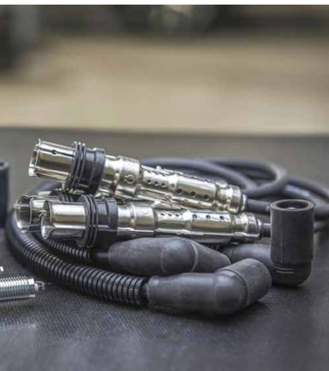
Bougiekabels en bobines spelen een belangrijke rol in het ontstekingsstelsel van een verbrandingsmotor
