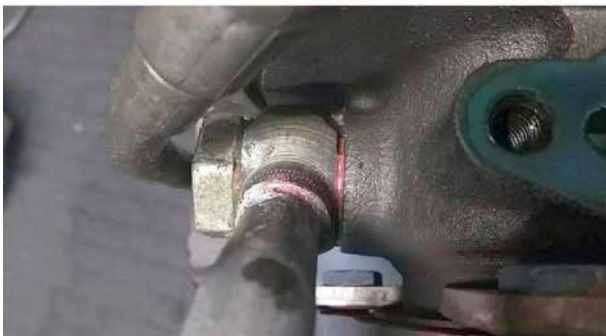
Foto 1 + 2 - Er is koelvloeistoflekkage zichtbaar bij de aansluiting van de leiding voor de koelvloeistof
