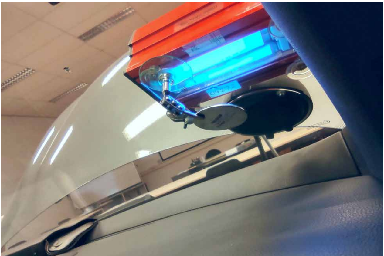
Door middel van een uv-lamp wordt op het einde van het herstel de hars gedroogd
