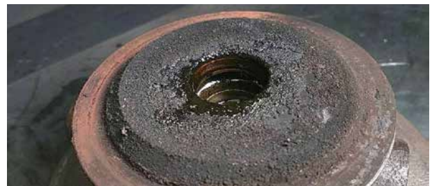
Foto 7 - Ook de koolopbouw aan de turbinezijde van het lagerhuis is het gevolg van extreme hitte
