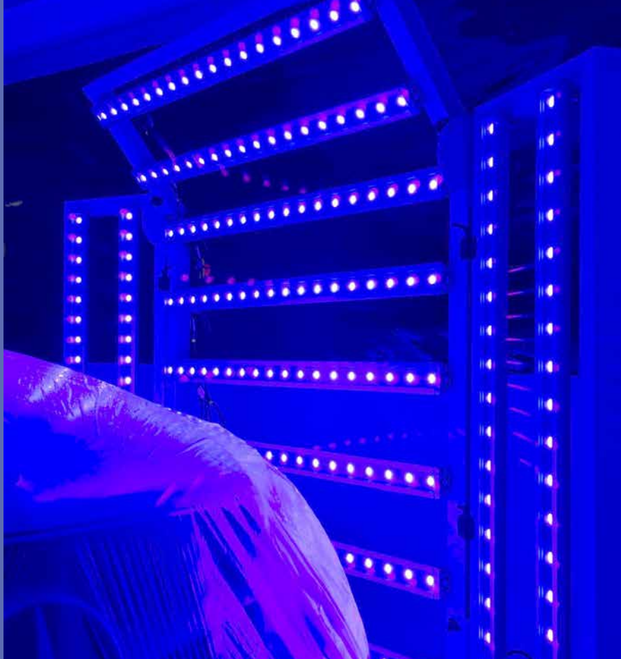
Drogen met uv-lichten komt ook uw energierekening ten goede (Foto: AkzoNobel)
