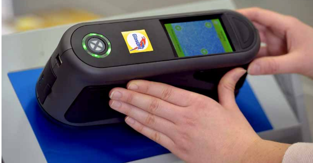
Een fotospectrometer kan een carrossier sneller en nauwkeuriger laten werken (Foto: BASF)
